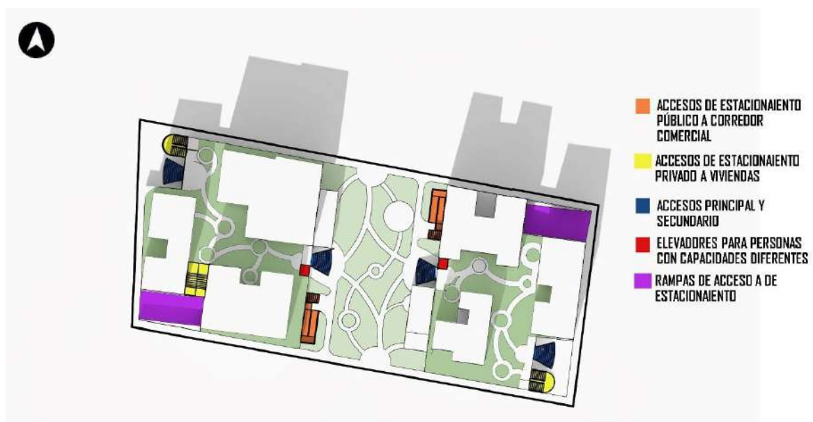
Esquema 10. Muestra las diferentes formas de acceder a los conjuntos A y B, y al corredor comercial. Fuente: Elaboración propia.
