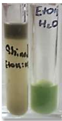
Figura A.V Reacción de Shinoda en el extracto hidroalcohólico. Fotografía tomada en el laboratorio de desarrollo de métodos analíticos de campo 1, FES Cuautitlán. Elaboración propia
