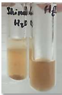
Figura A.IV Reacción de Shinoda en el extracto acuoso. Fotografía tomada en el laboratorio de desarrollo de métodos analíticos de campo 1, FES Cuautitlán. Elaboración propia
