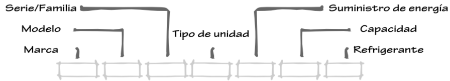
Diagrama 2.8 Caracterización de equipos de Aire Acondicionado Fuente: Elaboración propia
