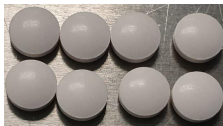
Imagen 5.8 Punzones después del proceso de compresión y tabletas obtenidas a una concentración de 4% de lubricante.
