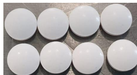
Imagen 5.7 Punzones después del proceso de compresión y tabletas obtenidas a una concentración de 3% de lubricante.
