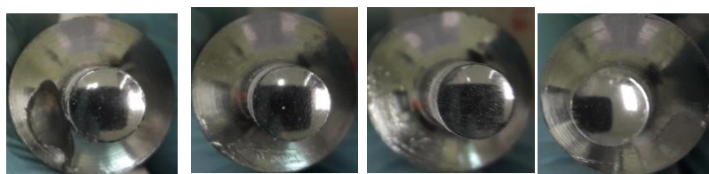
Imagen 5.7 Punzones después del proceso de compresión y tabletas obtenidas a una concentración de 3% de lubricante.
