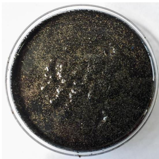
**Figura 5.3.** Lodo granular del reactor UASB (Grupo Modelo, CDMX)
