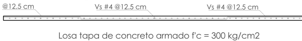
Imagen 33 Sección de losa tapa
