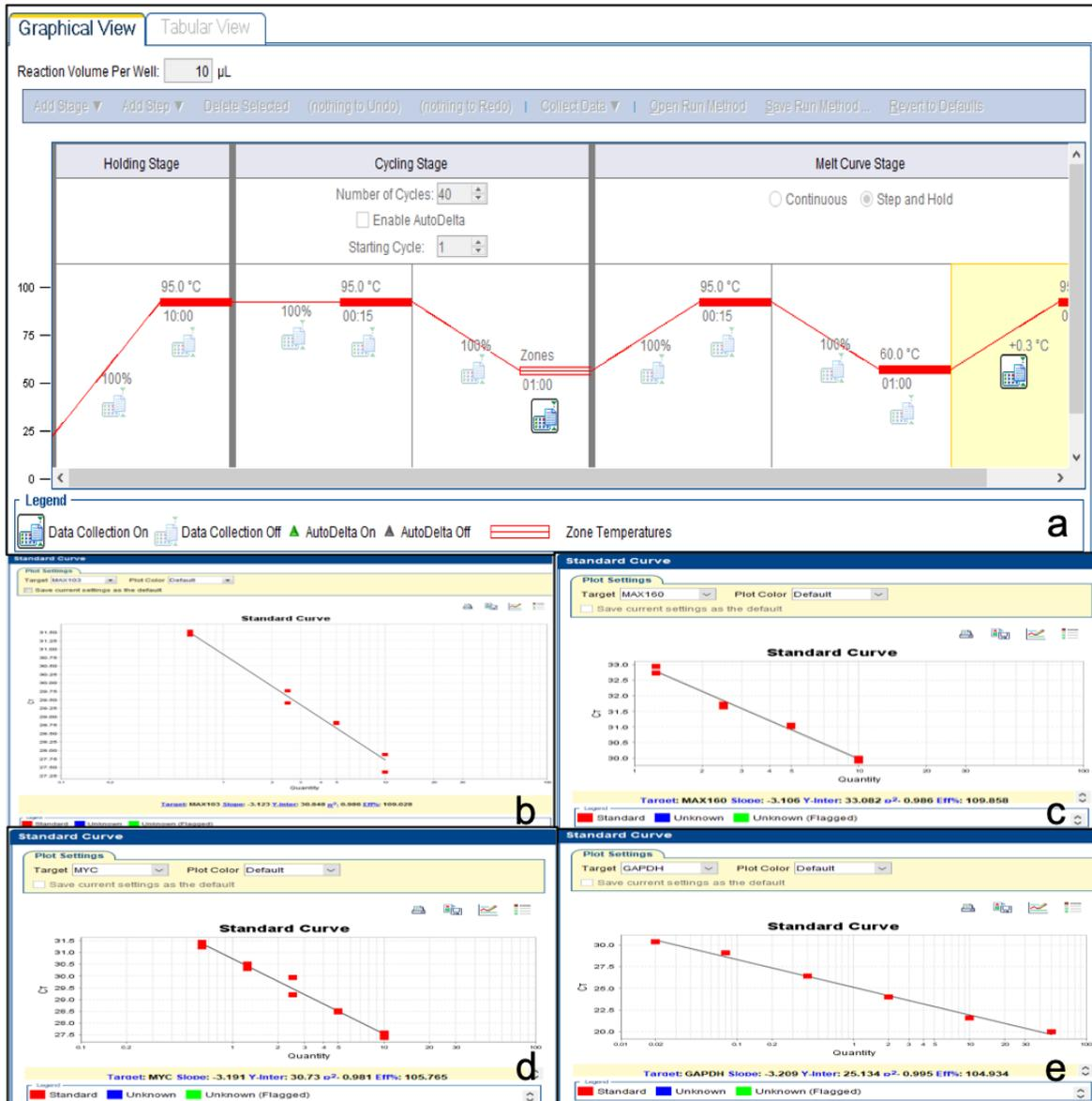
Figura 8: a) Especificaciones de las condiciones de reacción utilizadas para las reacciones SYBR Green I en StepOne Plus (Applied Biosystems). b) Curva de estandarización MAX-103. c) Curva de estandarización MAX-160. d) Curva de estandarización MYC. e) Curva de estandarización GAPDH.
