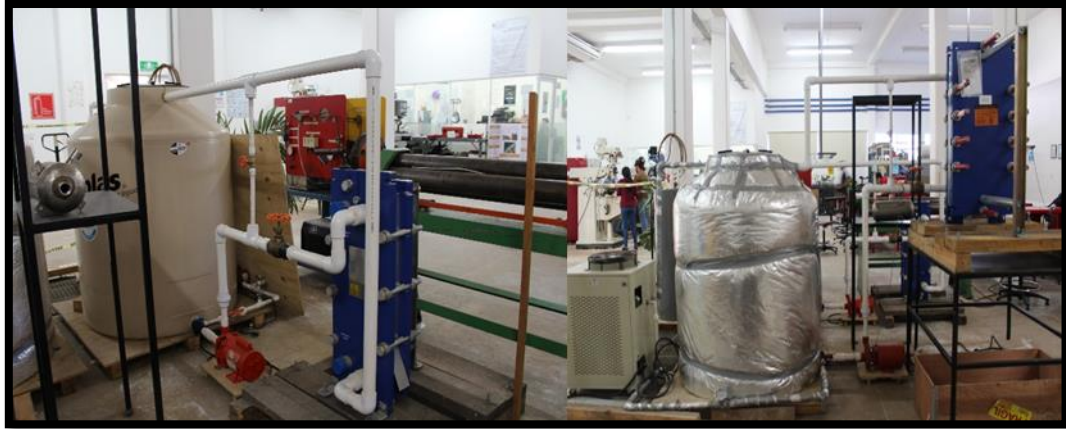
Figura 19. Prototipo OTEC de 1 kW en el Laboratorio de Ingeniería de la Universidad del Caribe, Quintana Roo, México
