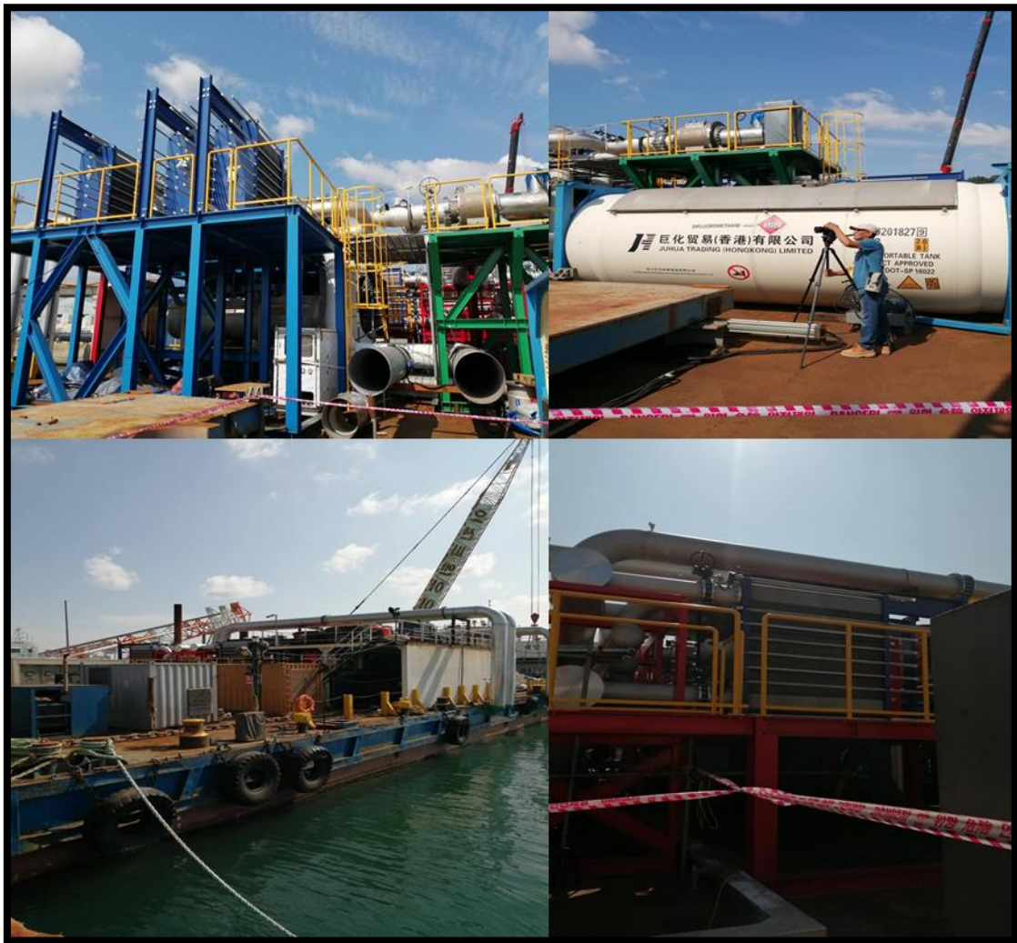
Figura 17. Prototipo OTEC de 1 MW en el muelle Wooam, Busan, Corea del Sur (fotos del autor)
