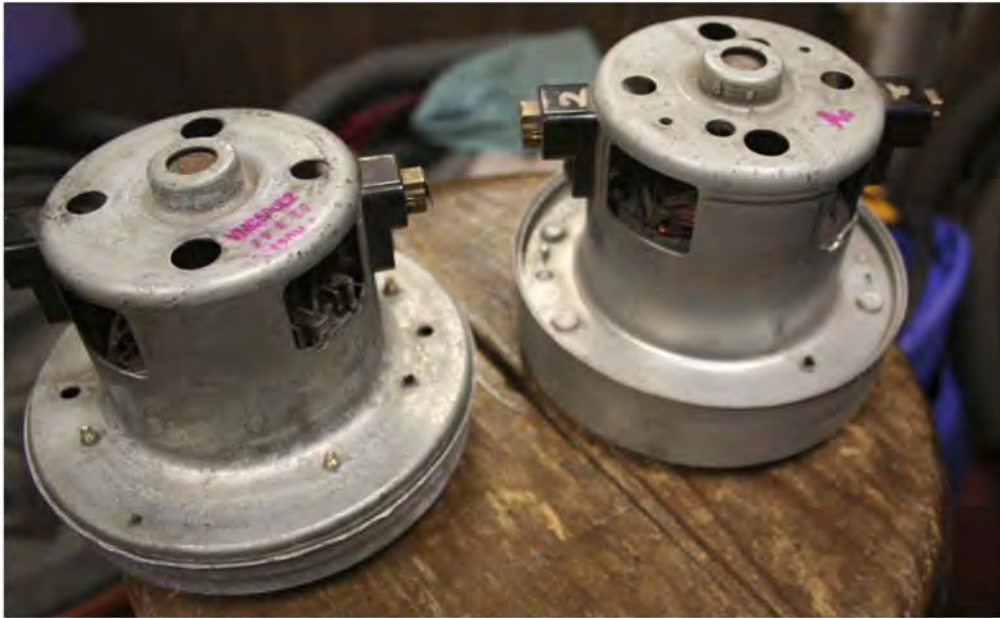
Figura 21. Piezas exactamente iguales, sin embargo una no se puede reparar porque se encuentra remachada.
