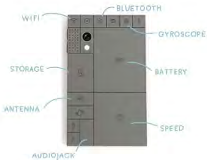
Figura 16. Diagrama explicativo del Phoneblok , celular formado por bloques desmontables. 119
