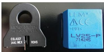
Figura 4.1: Sensores de corriente y voltaje del MVE.
