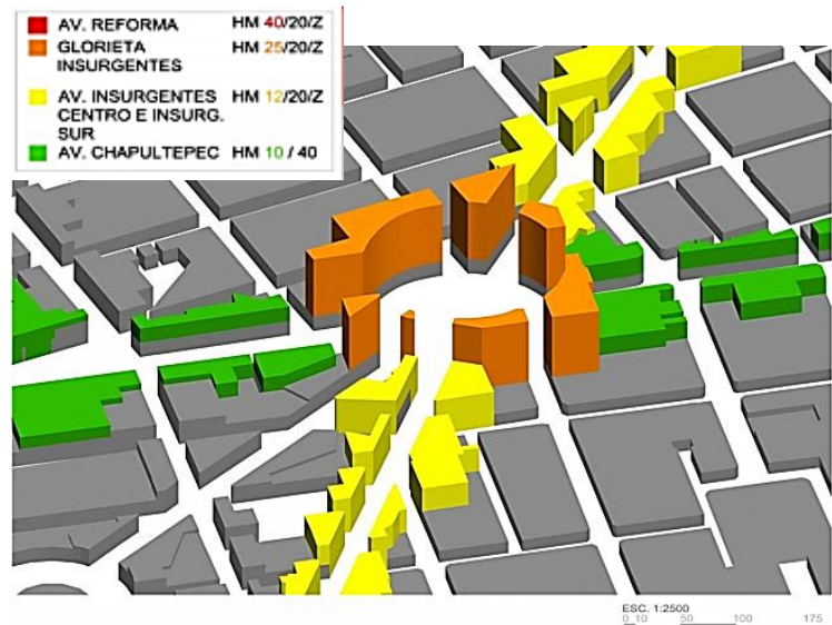
Imagen 9. Niveles permitidos por norma de vialidad Fuente: Programa delegacional de desarrollo urbano, Alcaldía Cuauhtémoc
