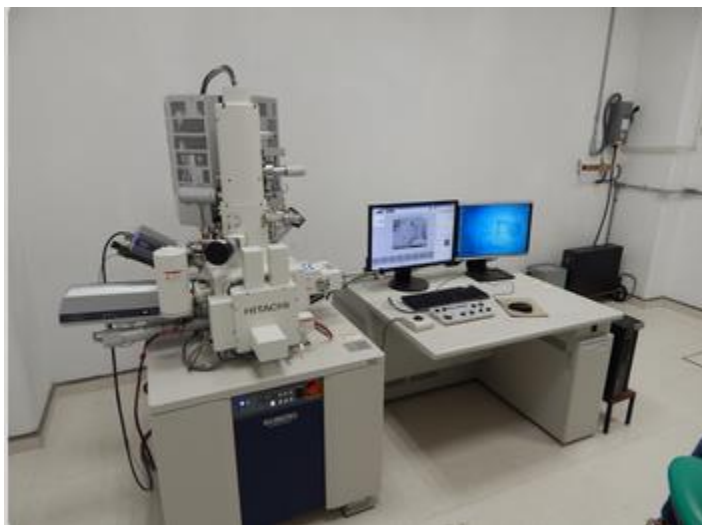
Figura 30. Microscopio electrónico de barrido (SEM), modelo SU8230, marca Hitachi.
