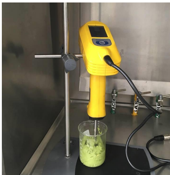
Figura 9. Empleo del ultrasonido en puré de aguacate.
