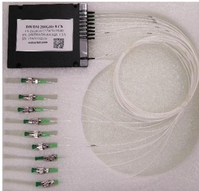
Figura 3.2: Mux/Demux óptico DWDM 200GHz 8 canales.
