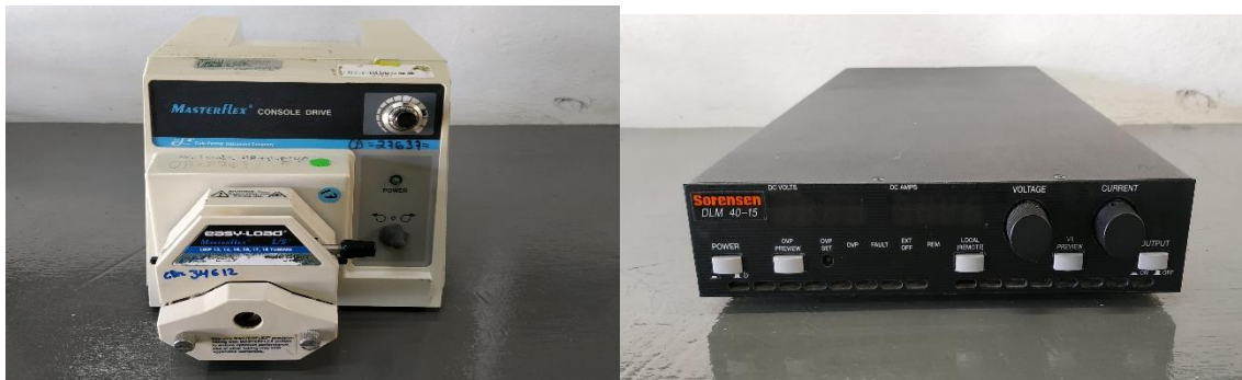
Figura 23 Bomba peristáltica y fuente de poder utilizados en los ensayos experimentales
