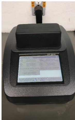
Figura 27 Espectrofotómetro DR2800 de la marca HACH
