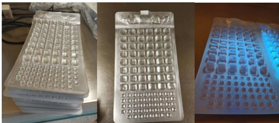
Figura 69 Placas de Colilert Quanti-Tray/2000 sin presencia de Coliformes (ausencia de coloración amarilla) y E.coli (fluorescencia)
