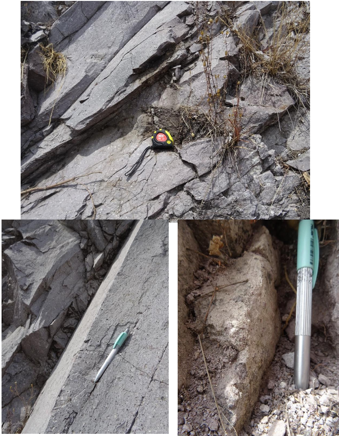
Figura 15. Condiciones de las discontinuidades a diferentes escalas.
