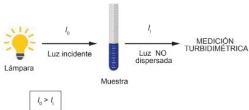
Figura 5. Esquema de funcionamiento de turbidimetría
