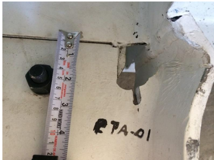
(b) Fractura en la muesca
