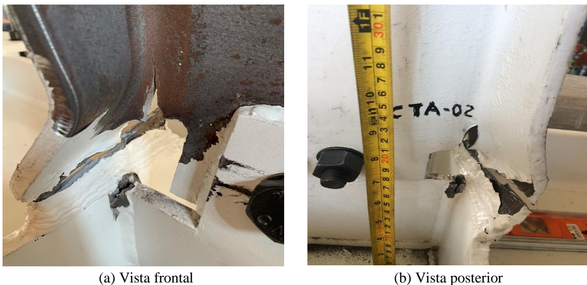
Figura 4.29. Falla en la muesca y patín del espécimen CTA-02
