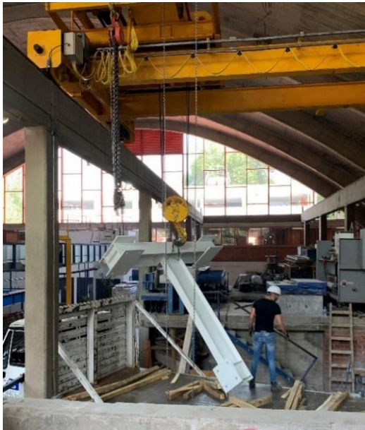
(a) Traslado y montaje del espécimen.
