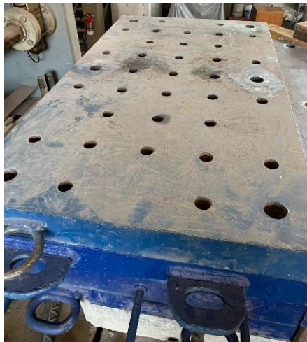
(b) Fotografía de la placa de apoyo existente en el laboratorio.
