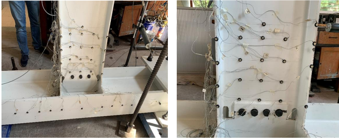
(b) Colocación de leds en la zona de la articulación plástica.
