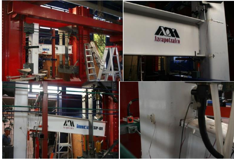
Figura 1.10. Ensayo del espécimen ECS1 realizadas en el Laboratorio de Estructuras UAM-A (Del Campo y Gómez, 2010)
