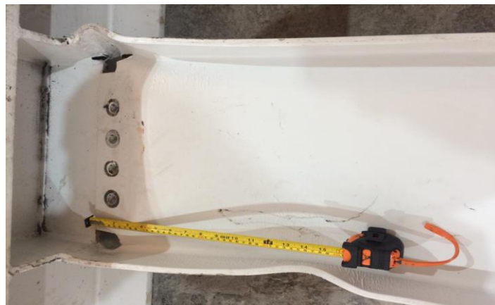
Figura 4.12. Longitud de la articulación plástica en el espécimen CTA-01
