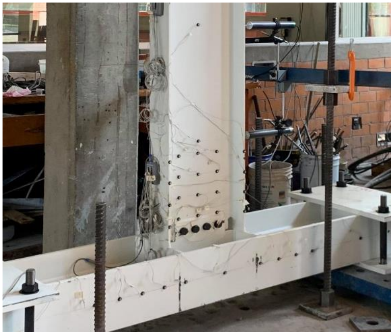
Figura 4.8. Especimen CTA-1 antes del inicio de la prueba experimental
