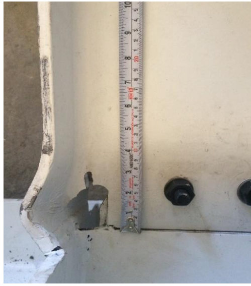
(b) Fractura en la muesca
