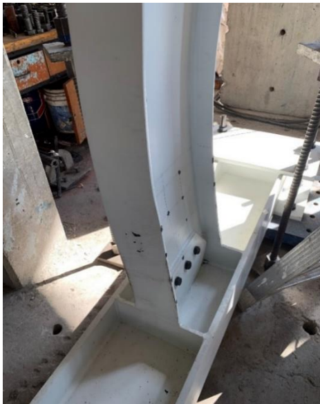
(a) Vista de la conexión ensayada
