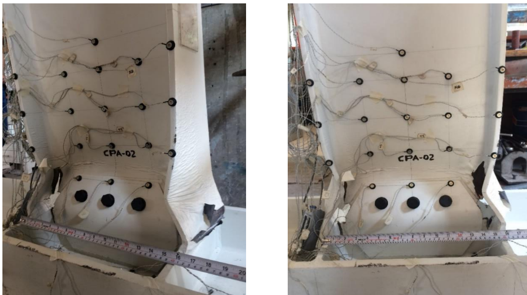
Figura 4.38. Vista de la zona dañada del espécimen CPA-02
