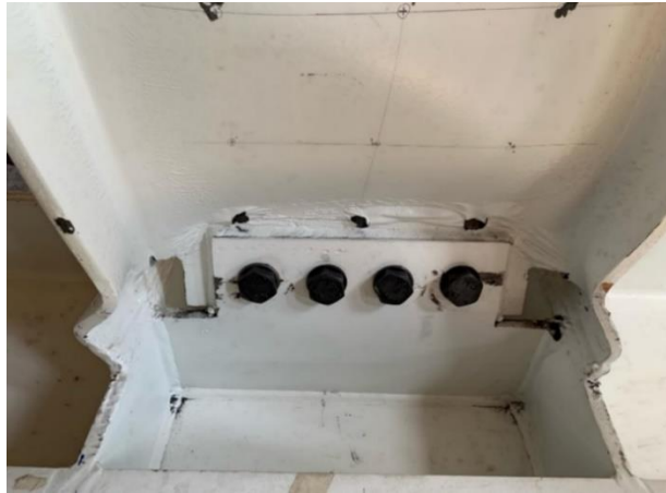
Figura 4.13. Concentración de demandas en el espécimen CTA-01
