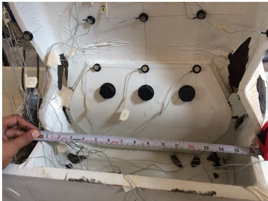
Figura 4.36. Estado final del espécimen CPA-02 (vista frontal)
