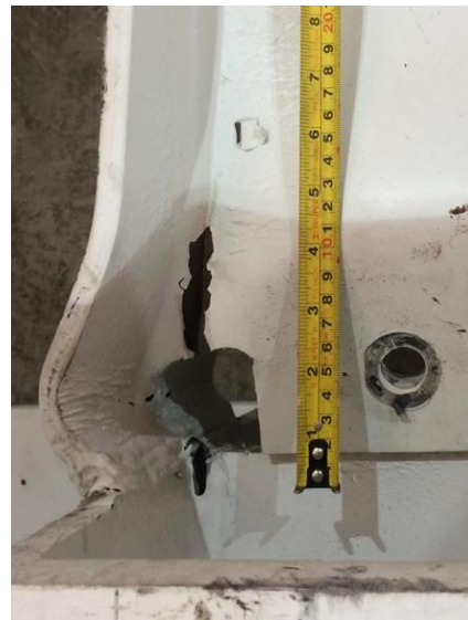
(b) Acercamiento en la fractura
