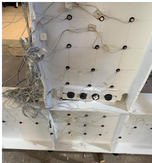
(b) Colocación de leds en la articulación plástica y en la zona del panel.
