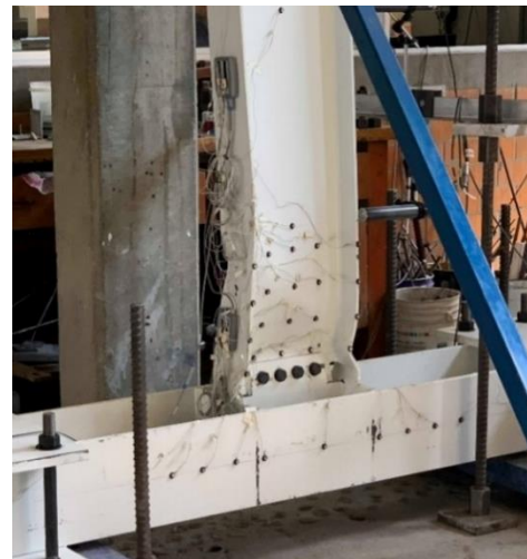
(b) Especimen CTA-01 después de la prueba experimental.
