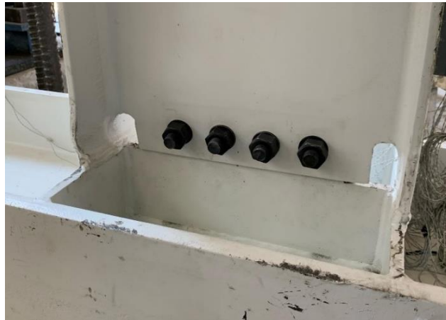
Figura 4.9. Inicio del pandeo en los patines adyacentes a la muesca al finalizar los 6 ciclos de \theta=0.0075 rad (17.6 mm)
