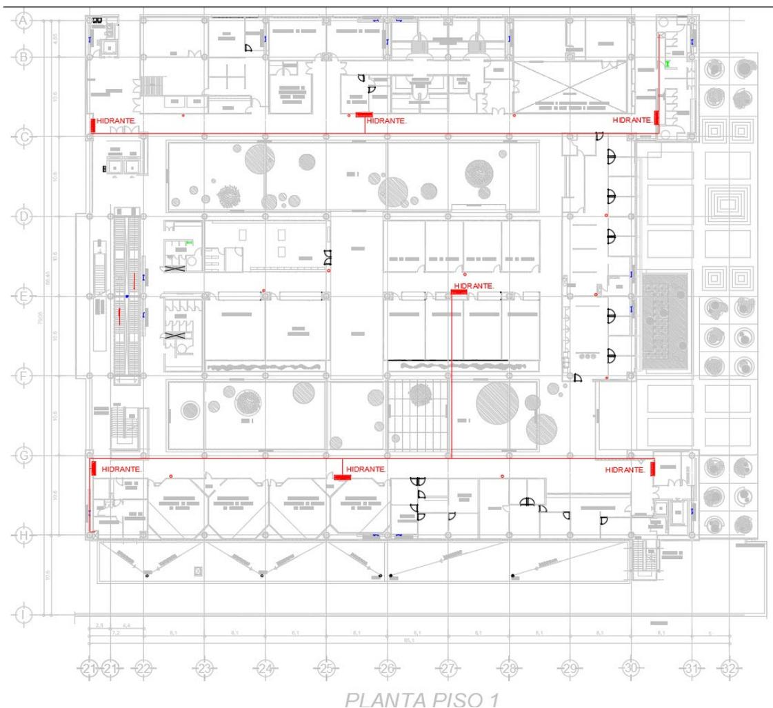
**Fig. 15 Red de hidrantes de la planta piso 1.**
