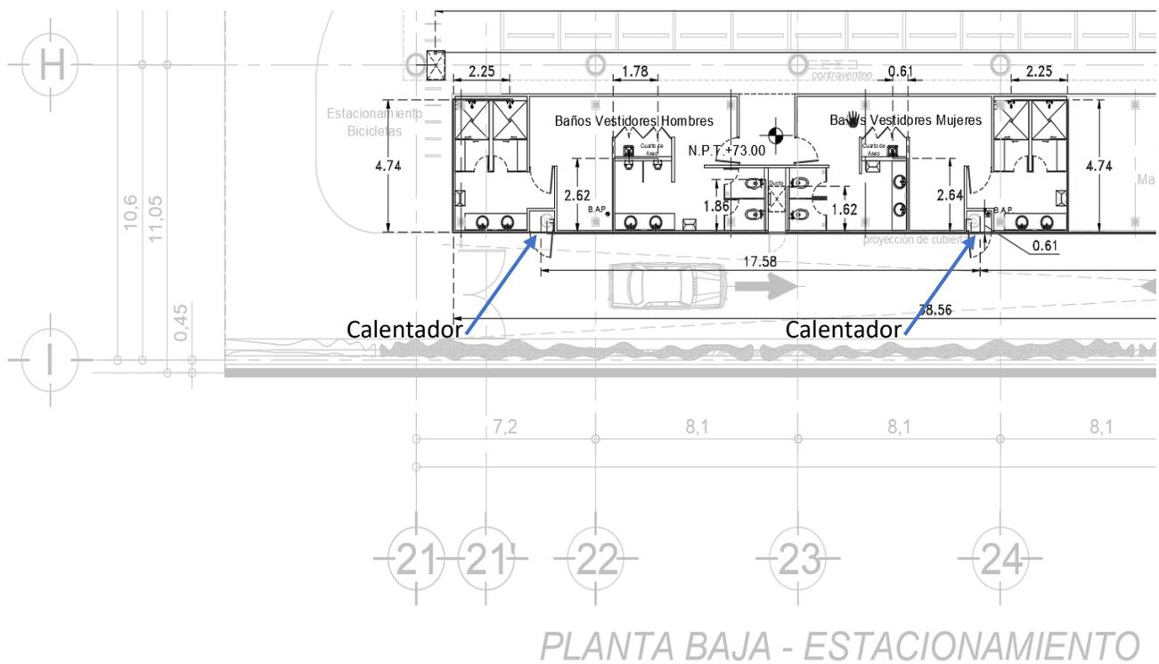
Fig. 11 Ubicación del calentador de agua.
