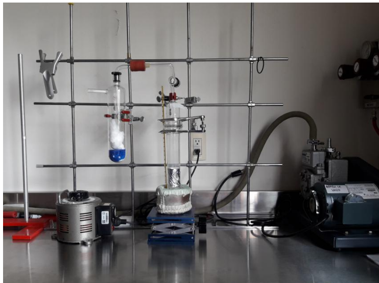
Figura 19. Sistema de funcionalización que consiste de un reactor Pyrex conectado a una bomba de vacío soportado en una mantilla de calentamiento.
