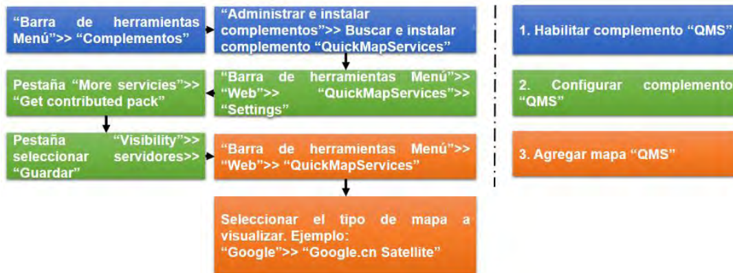
Figura 3.24. Procedimiento para agregar el complemento "Quick Map Services" en QGIS. Fuente: Elaboración propia.
