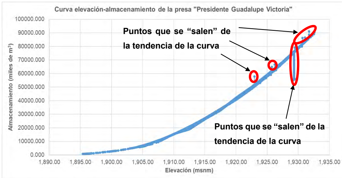
Figura 2.11. Ejemplo de una curva elevación-almacenamiento (CEV) de una presa, generada con información de la base de datos del BANDAS. Fuente: CONAGUA (2020).
