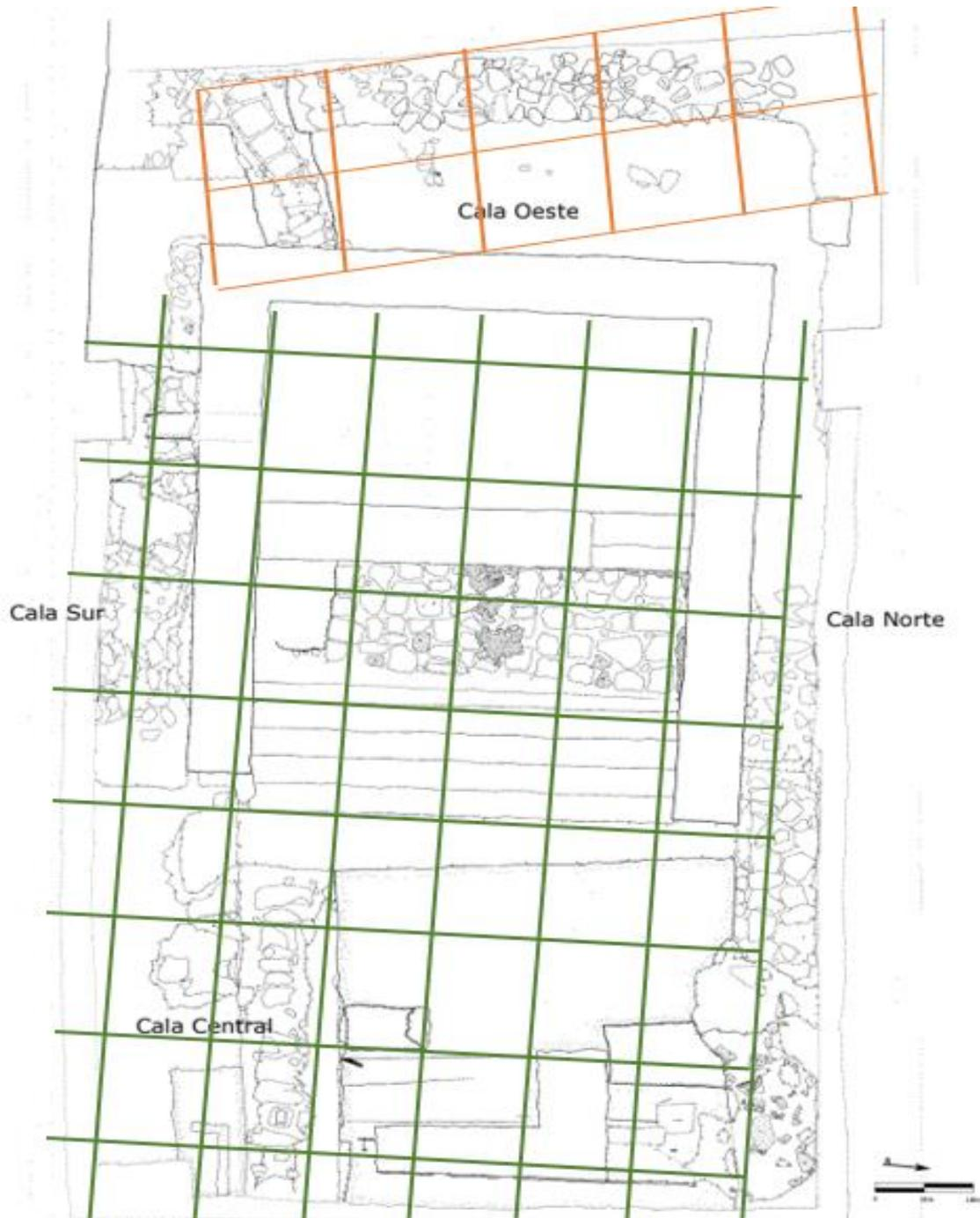
Figura 14. Plano de la excavación final de la Caja de Agua. Ubicación de las calas en la exploración, junto con su retícula correspondiente. Tomado de Sánchez de Bustamante (2017).
