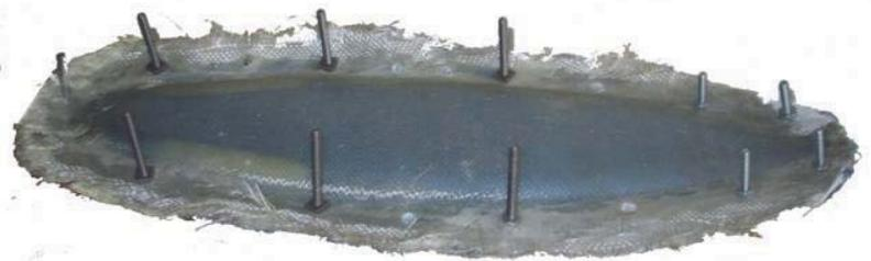
Molde a escala con espuma y material compuesto y tornillos para mantener la presión de la espuma.
