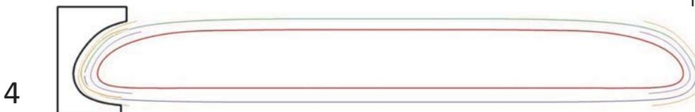
**3** Se vacía la espuma en el interior de la fibra. El molde exterior permite que el material compuesto soporte la enorme presión generada por la espuma (hasta 45 psi).
