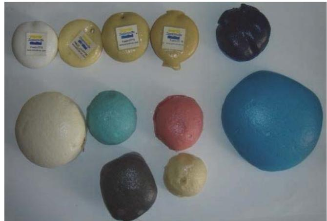
Imagen que muestra las diferentes pruebas con espumas. Se puede observar la diferencia de tamaño, tomando en cuenta que se usó siempre la misma cantidad del material, se puede obtener los diferentes índices de expansión. Se colorearon las muestras tanto para ver las posibilidades de color como para distinguir las diferentes espumas.
