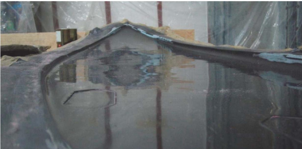
Una vez obtenidos los moldes se pulieron para que tuvieran el acabado final. Se construyó una mesa donde se fijo la base para evitar deformación al fabricar la tabla.
