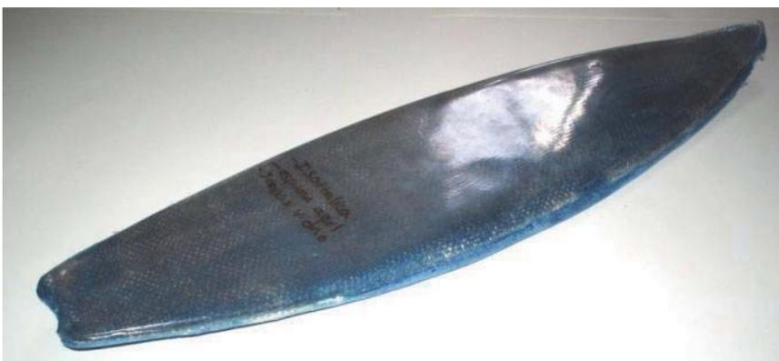
En esta imagen se observa el acabado disparejo, debido a que se quedo mucho aire atrapado, y por causa de esto, las aéreas de la tabla que están en contacto con el aire se secan a una velocidad diferente, por lo que aparecieron fisuras, cuarteaduras y arrugas en la superficie de la tabla.
