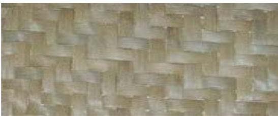
Material compuesto realizado para probar su resistencia, hecho de entramado de henequén y resina Isoftalica.
