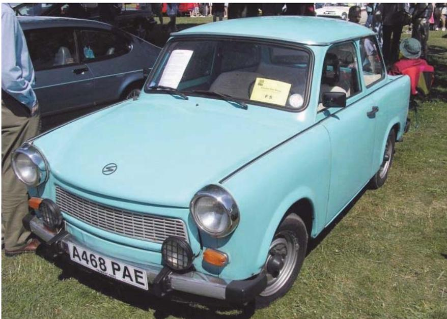
“Trabant”, automóvil fabricado con fibras de algodón y resina Epoxica, se fabricaron durante 10 años, (1950-1960) en la República Democrática de Alemania, se fabricaron mas de 10,000 unidades y el 40% sigue en circulación hoy en día. El material compuesto de la carrocería tenía una capa intermedia de aserrín para aumentar la rigidez. El grosor de el material era de casi 1cm.
