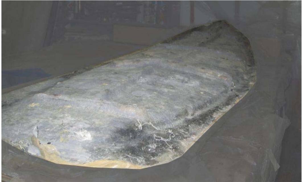
En la imagen superior se observa el molde cerrado y montado sobre la mesa. La parte superior cuenta con costillas estructurales insertadas dentro del laminado para maximizar la rigidez. En la imagen inferior se pueden ver las dos piezas del molde abiertas y preparadas para recibir el laminado.
