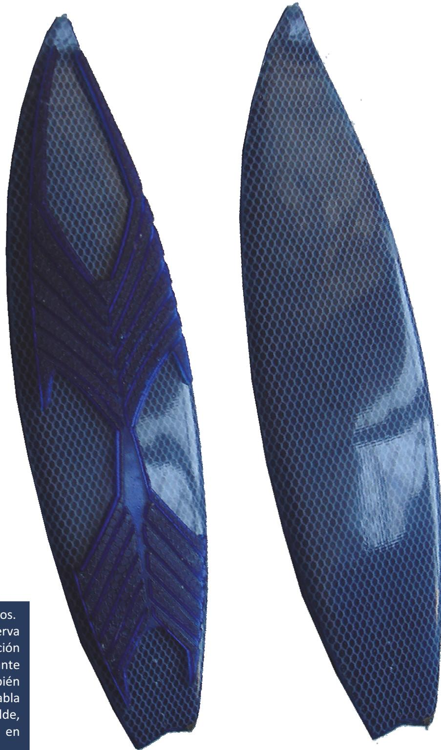
Modelos a escala ya terminados. En el de la izquierda se observa la tabla terminada con la adición de la capa de antiderrapante hecha de uretano también coloreado. A la derecha la tabla terminada como sale del molde, con la espuma ya inyectada en su interior.
