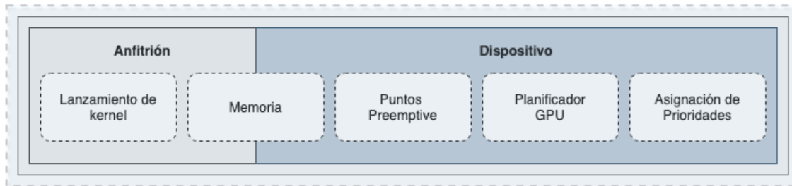
Figura 4.1: Esquema del framework para la planificación de tareas preemptive en sistemas embebidos heterogéneos.
