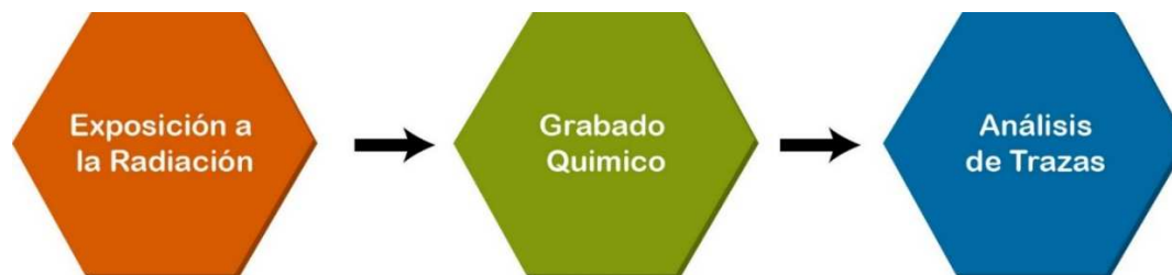
Figura 2.1 Diagrama del método para la detección por trazas nucleares en sólidos.
