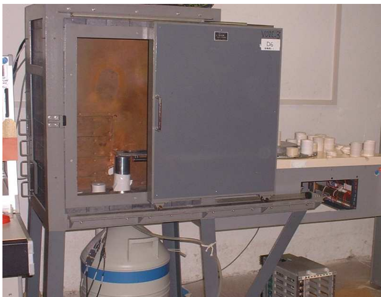
Figura 1.9 Detector de Activación Inducida, Cartel Detección de neutrones mediante la Metodología de Trazas Nucleares en Sólidos, IFUNAM.
