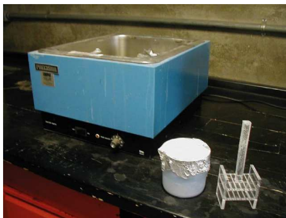
Figura 3.4 Instrumentación básica para el grabado químico empleada en el PAD del IFUNAM.
