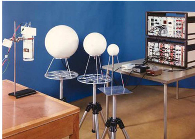
Figura 1.8 Esferas de Bonner, Cartel Detección de neutrones mediante la Metodología de Trazas Nucleares en Sólidos, IFUNAM.
