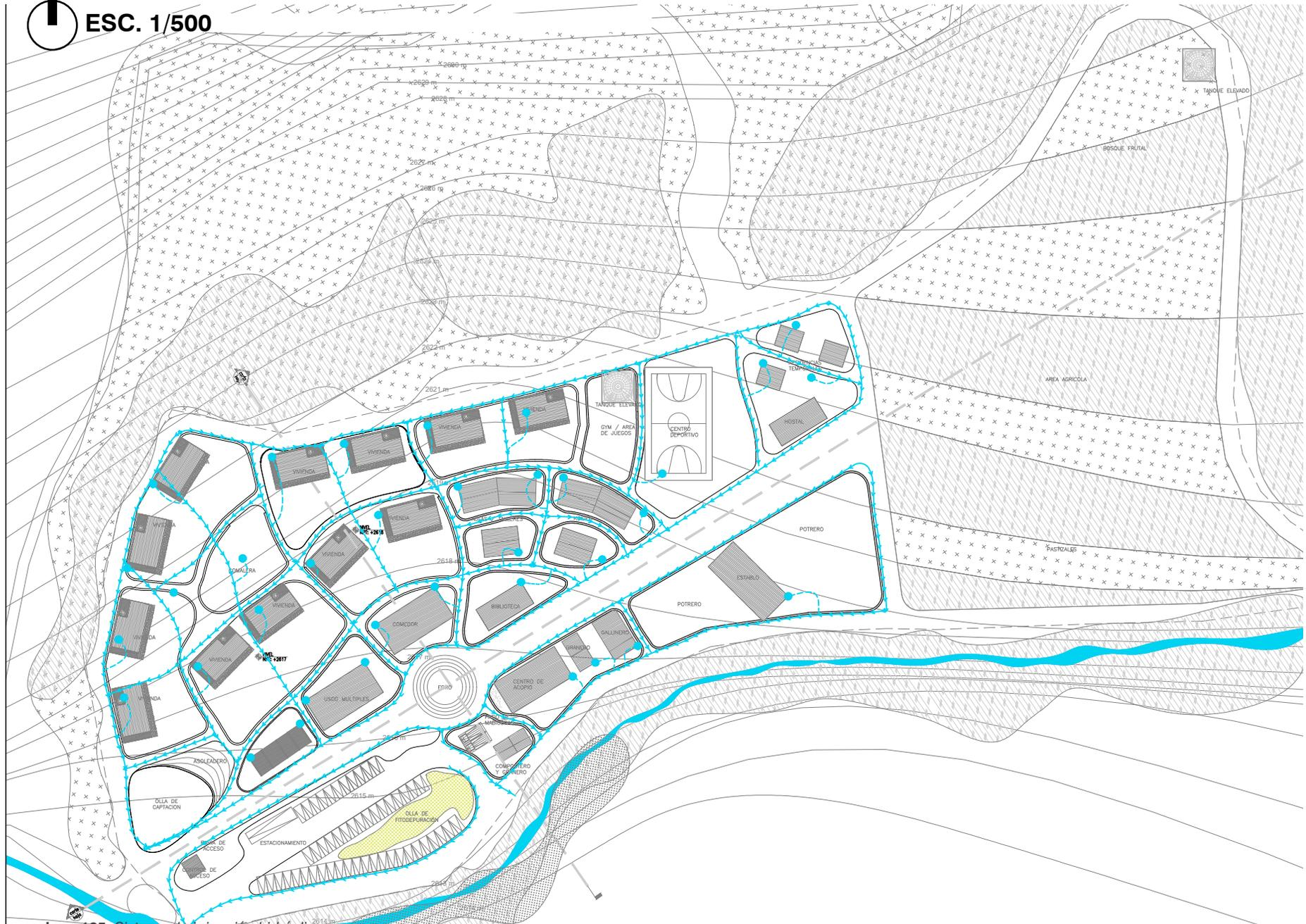
Img. 125. Sistema de irrigación hidráulica
