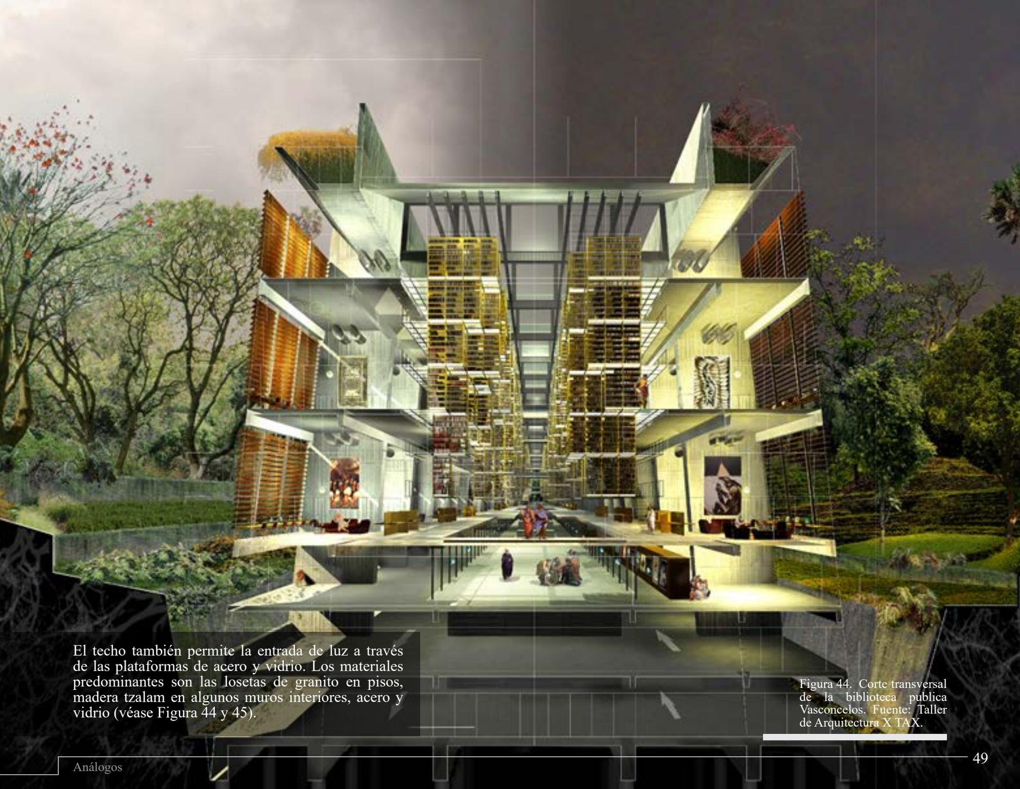
El techo también permite la entrada de luz a través de las plataformas de acero y vidrio. Los materiales predominantes son las losetas de granito en pisos, madera tzalam en algunos muros interiores, acero y vidrio (véase Figura 44 y 45).
