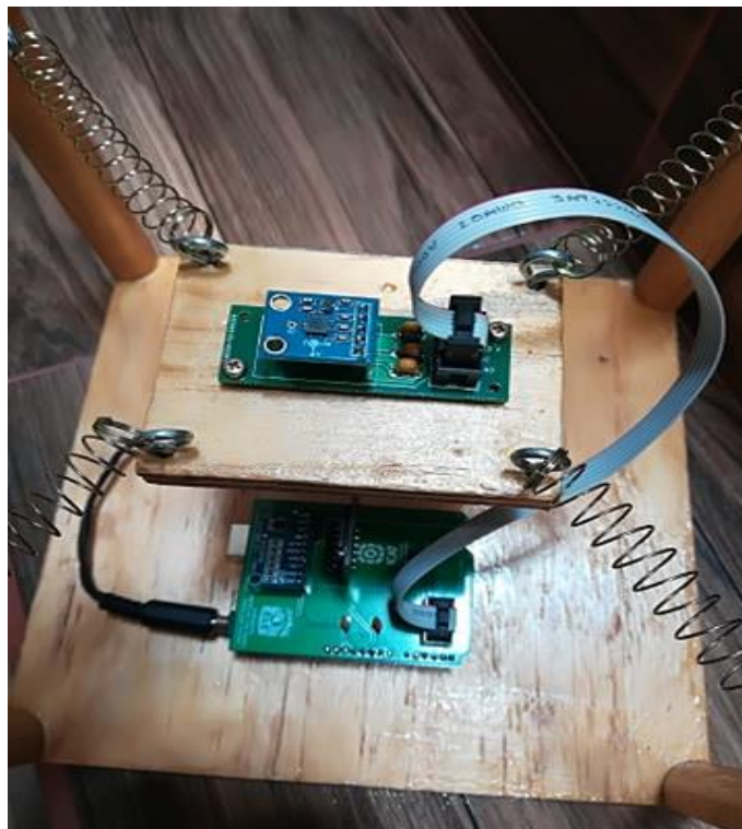
Figura 3.26 En esta imagen se muestra el sismógrafo electrónico terminado, se utilizó una base de madera para mantener una rigidez de los componentes al igual que 4 postes en cada esquina para suspender al acelerómetro y poder percibir oscilaciones provenientes del suelo.
