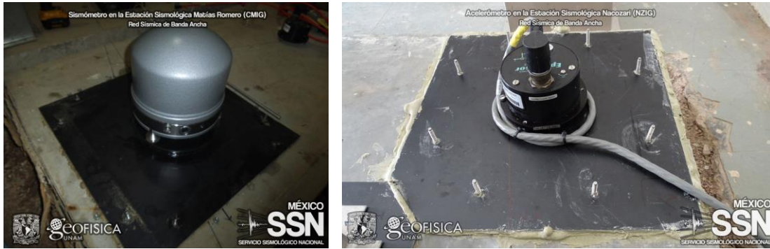
Fig. 1.4 En esta imagen, se aprecian las fotografías de un sismómetro (izquierda) y un acelerómetro (derecha) que son usados en las estaciones del SSN. Imagen tomada de: http://www.ssn.unam.mx/acerca-de/estaciones/
