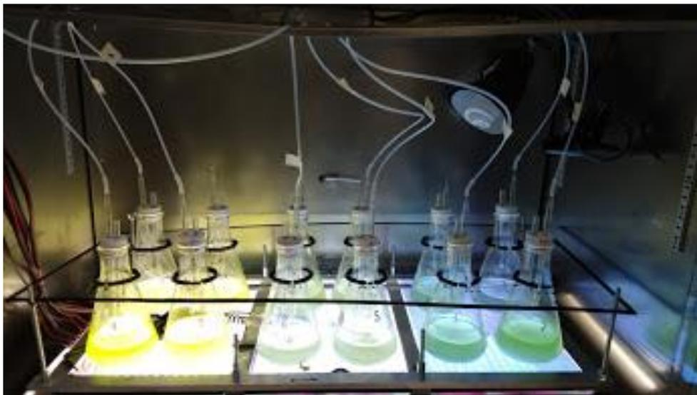
Figura 26. Sistema experimental con diferentes intensidades luminosas. El sistema permite el control de la intensidad luminosa, temperatura, agitación y suministro de carga de CO<sub>2</sub>.
