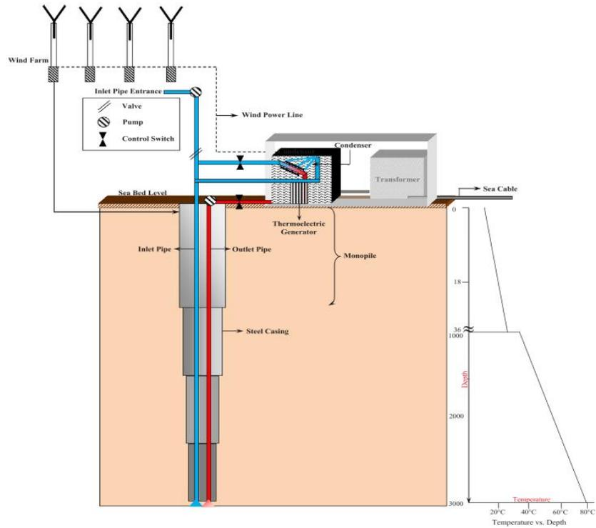
Fig. 23" Ciclo de funcionamiento del dispositivo basado en el efecto Seebeck (Banerjee, et al., 2018) "
