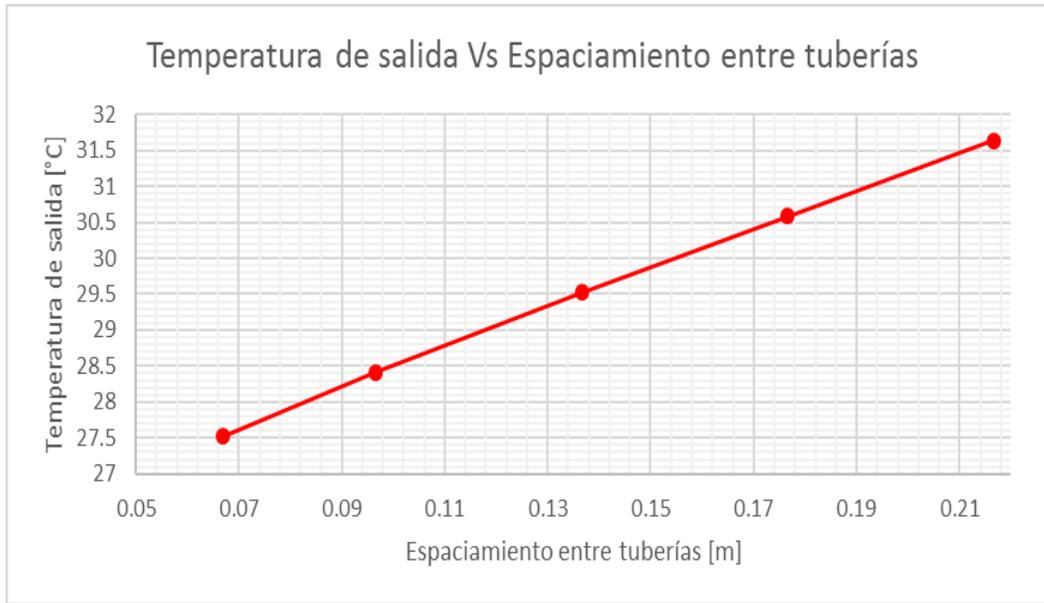
Fig. 62 “Variación del espaciamiento entre tuberías (Autor)”
