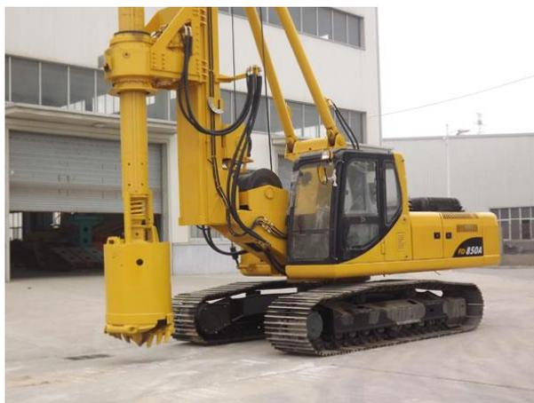
*Fig. 38 " Perforadora rotatoria (FDM, 2014) "*
