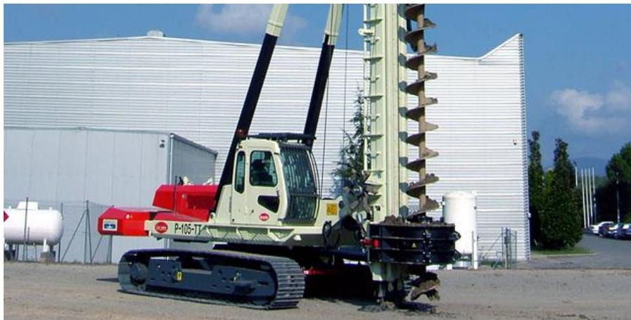
*Fig. 40 " Perforadora de hélice continua (LLamada-, 2012) "*
