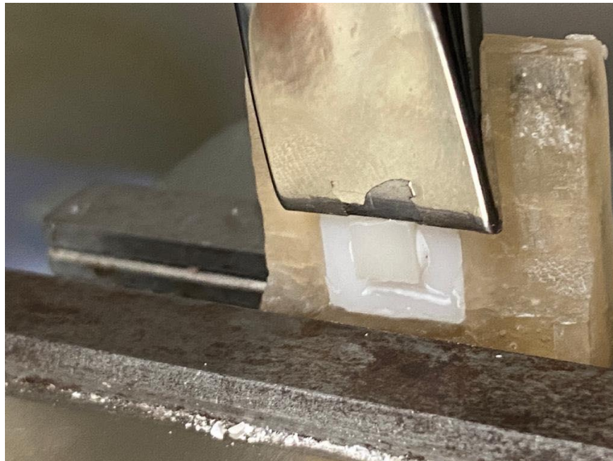
Imagen 13: Prueba de resistencia al descementado (fuente propia)
