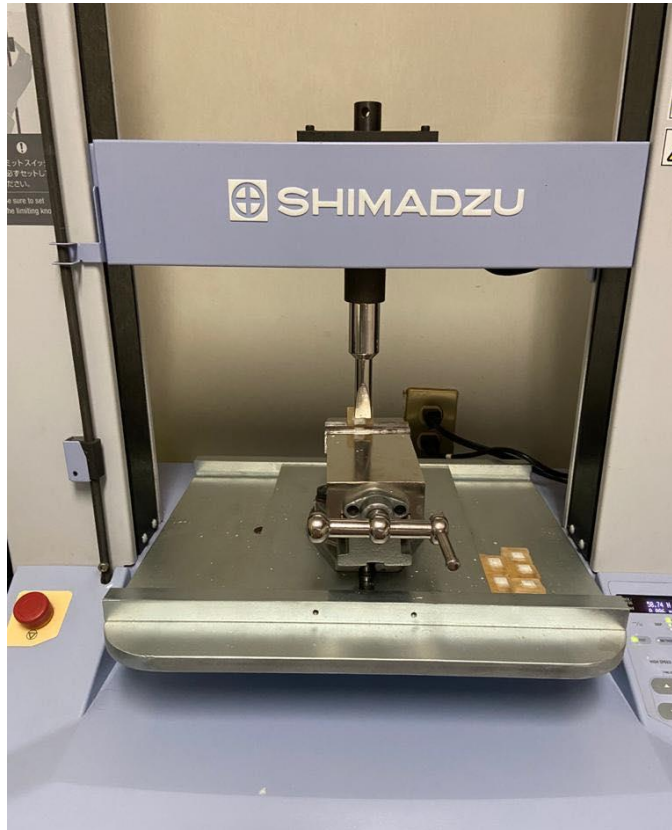
Imagen 11: Máquina de ensayos universales (Autograph AGS-X, Shimadzu Corp., Kioto Japón) (fuente propia)
