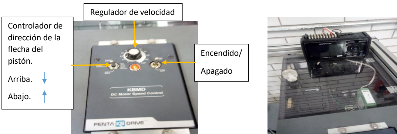
Figura 2.1-3 Sistema de control para operar el equipo; Tablero de control para accionar el pistón (a) y equipo de recopilación de datos (b).
