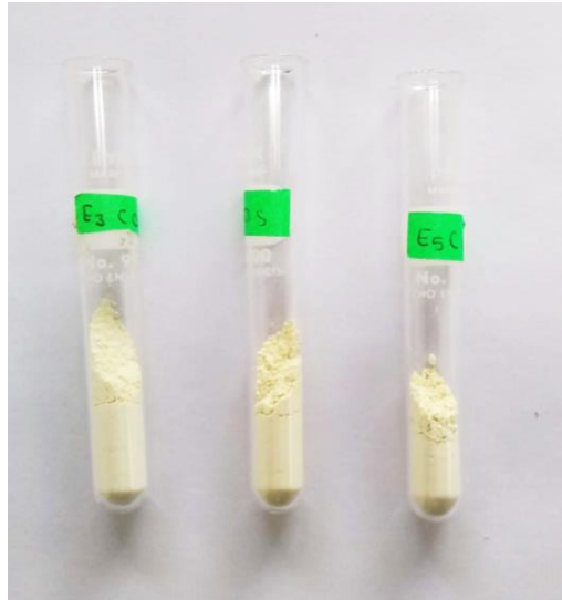
Figura 3.14 Pigmentos x= 0.3, 0.5 y 0.7 ; método de reacción en estado sólido.
