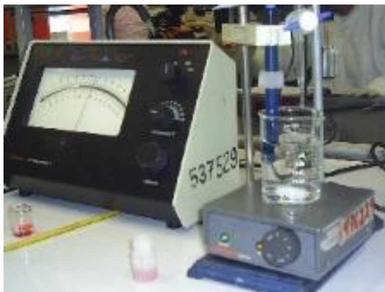
Figura 1.3-2. Montaje experimental de valoración potenciométrica con volúmenes de 50mL.
