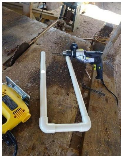
Figura 3.16 Estructura en forma de <<U>> de tubos de CPVC (Elaboración propia, 2019)
