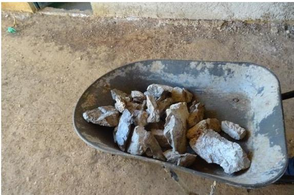
Figura 3.20 Roca para base del filtro de agregados (Elaboración propia, 2019)
