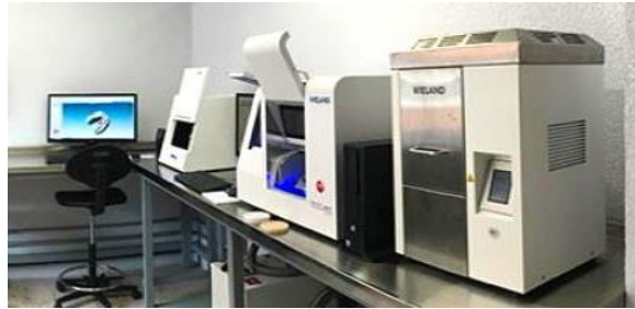
(fig. 13) 21 escáner, fresador y horno de sinterizado Weiland, Ivoclar
