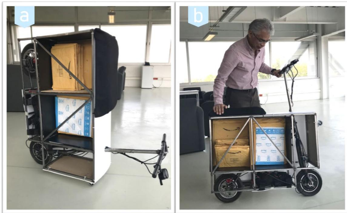
Figura 77. Prototipo final VUMi: a) modo maleta, b) modo vehículo.
