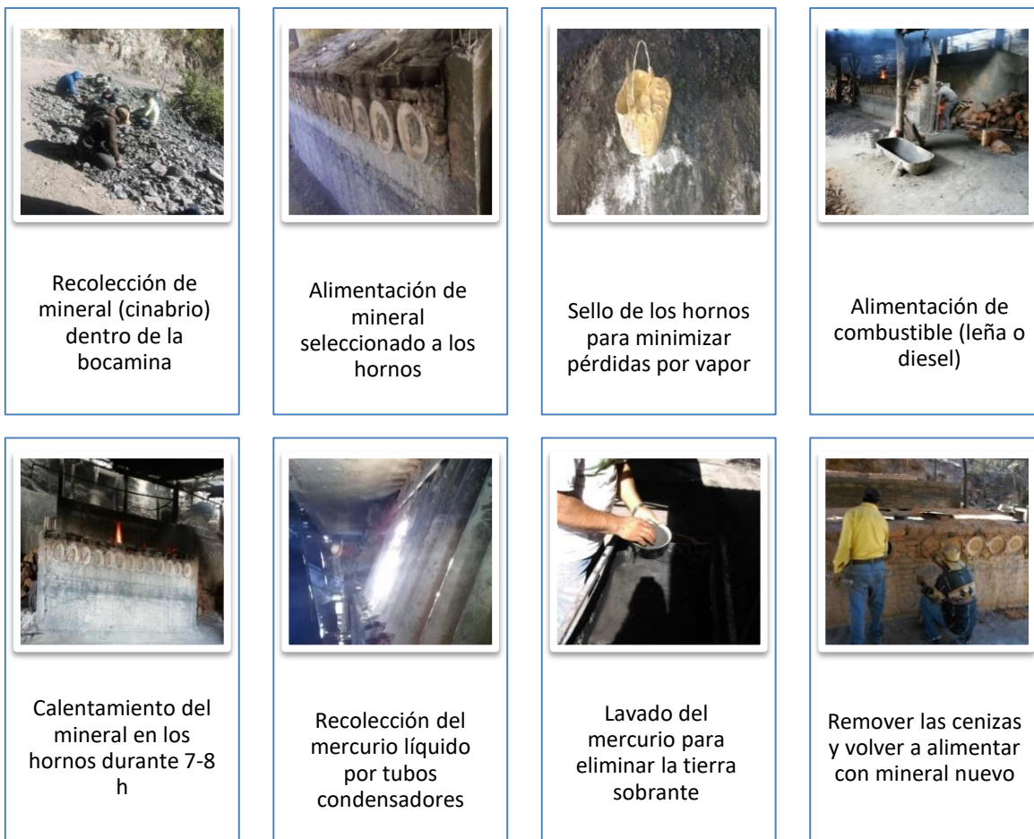
Figura 4.2 Proceso de extracción primaria artesanal de mercurio. Fuente: elaboración propia.
