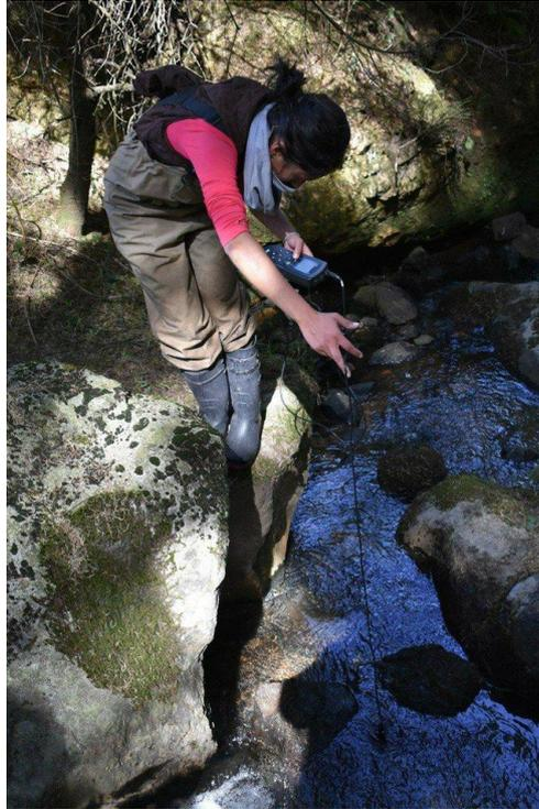
**Figura 8.** Toma de parámetros físico-químicos usando el multiparámetro portátil Hach HQ30D flexi. Foto tomada por Víctor D. Ávila Akerberg.
