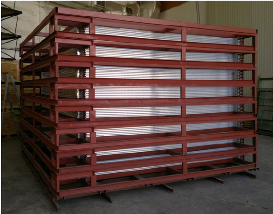
Figura 2.1. SciCRT instalado en Sierra Negra. El detector se divide en ocho Super Blocks. Tomada de [37].
