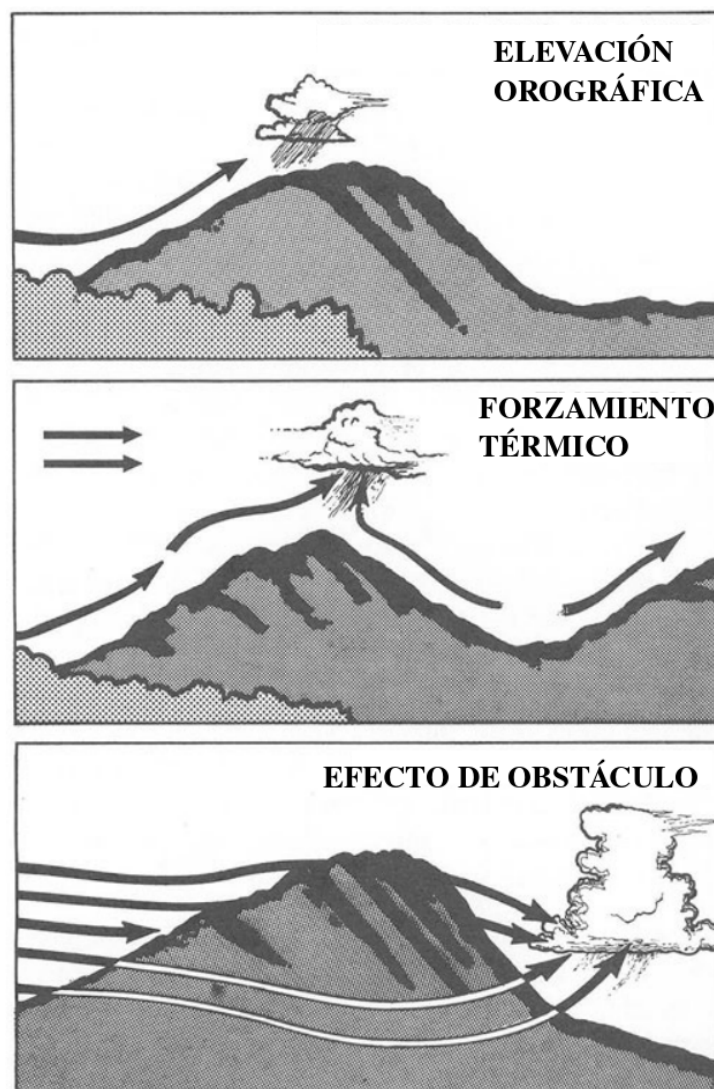
Figura 3.3. Tipos de mecanismos de formación de tormentas en una montaña: (a) Elevación orográfica directa al LFC, (b) Circulaciones (solenoidales) térmicamente forzadas y (c) Efecto de obstáculo o aerodinámico. Modificada de [48].
