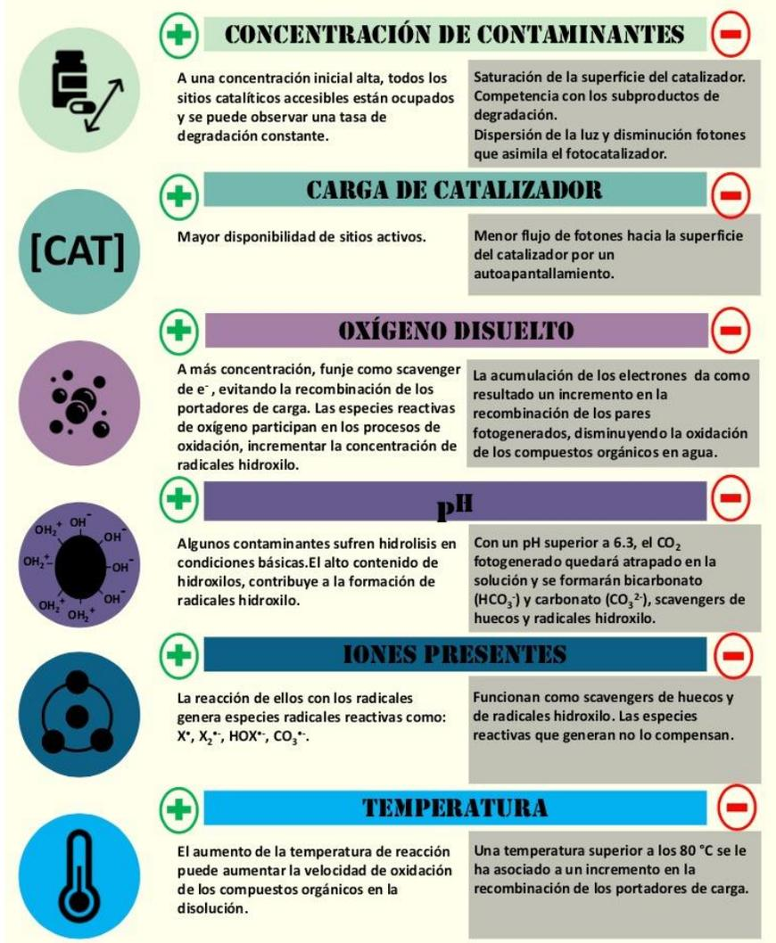
Figura 1.4 Efectos positivos y negativos alcanzados por la modificación de factores clave en el proceso de fotocatalisis heterogénea.
