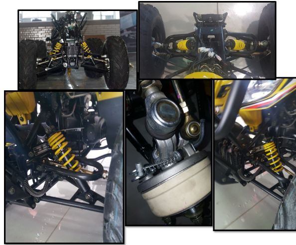
Figura 3.2: Suspensión de doble horquilla de la Motoneta Italika ATV 180 modelo 2018.
