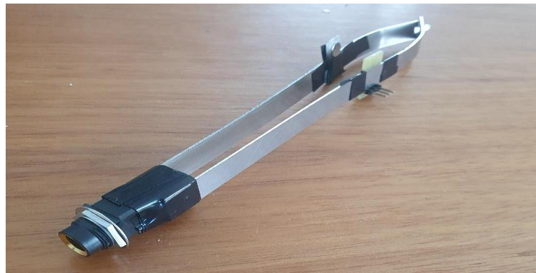
Figura 3.4. Prototipo final ensamblado, adaptado al conector Jack hembra y con el sensor de efecto Hall e imán adaptados.
