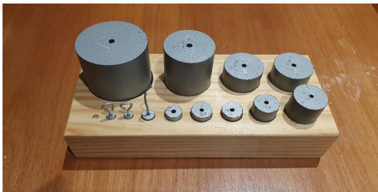
Figura 4.3. Juego de pesas de laboratorio utilizado para la caracterización del sensor de fuerza resistivo.
