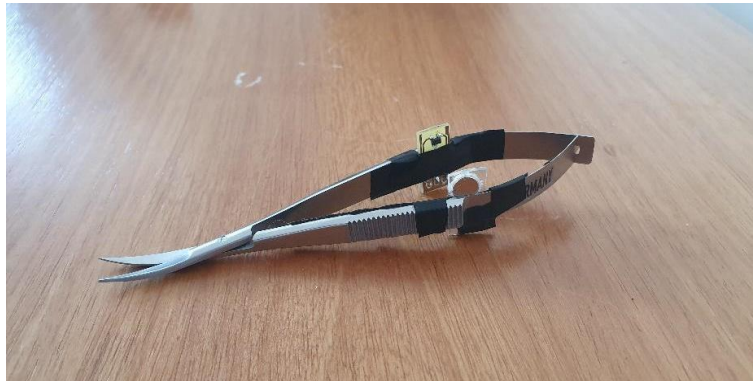
Figura 3.5. Tijera quirúrgica adaptada con sensor de efecto Hall e imán de neodimio.
