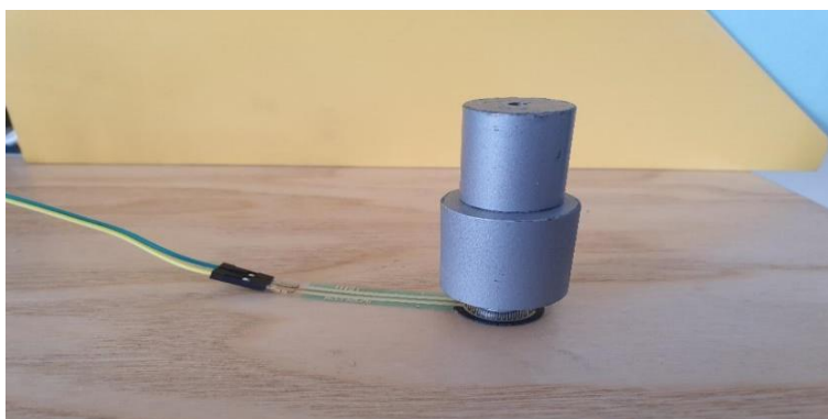
Figura 4.4. Muestra de pesas colocadas sobre el sensor resistivo para su lectura de voltaje.
