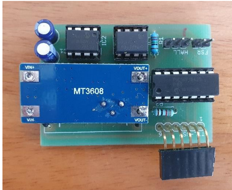
Figura 3.8. Implementación final del circuito de lectura de sensores y conexión al puerto USB de una computadora.
