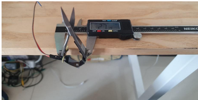
Figura 4.2. Lectura de valores de voltaje del sensor en la tijera quirúrgica.
