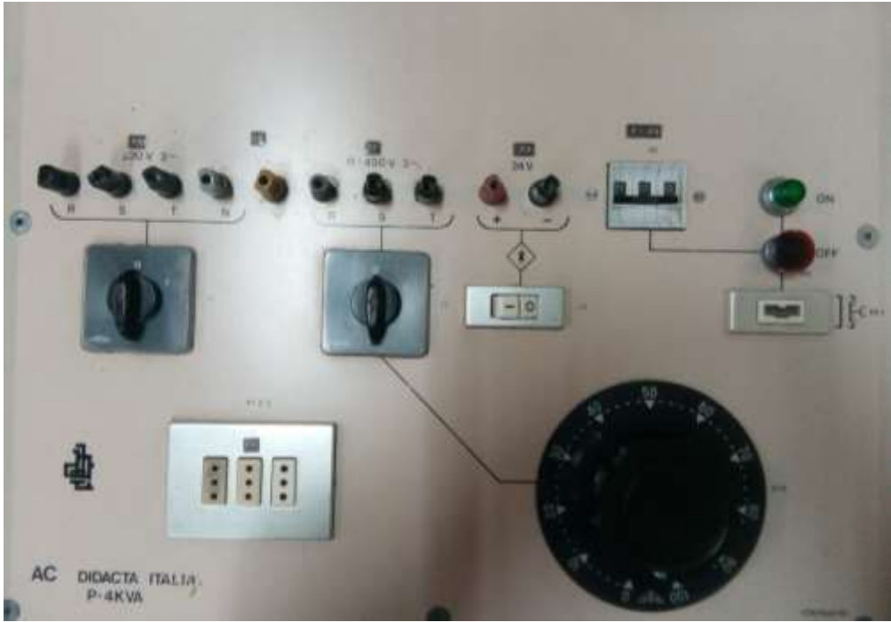
Figura 3-5. Fotografía frontal del alimentador de corriente alterna D01234.
