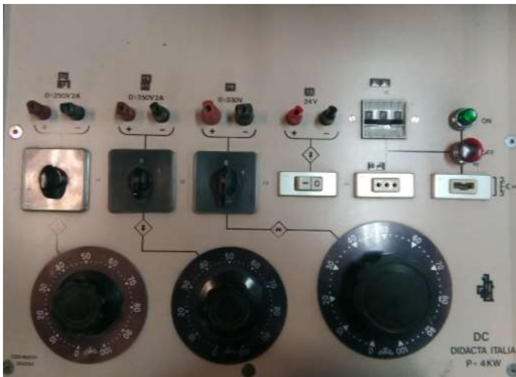
Figura 3-8. Fotografía frontal del alimentador de corriente continua D01233.
