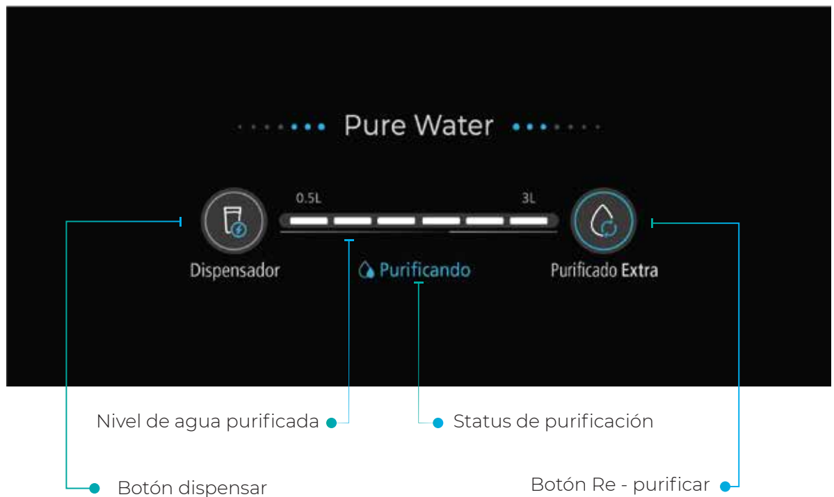
Figura 65 – Interfaz del sistema de purificación de agua
