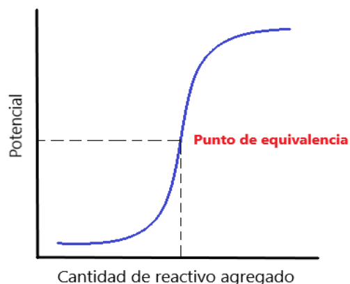
Figura 24. Representación gráfica de una valoración potenciométrica. Determinación del punto final.
