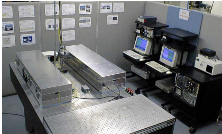
Figura 1.9: Experimento de criptografía cuántica de fibra óptica. Las dos cajas en primer plano contienen el interferómetro de Alice y el interferómetro de Bob (izquierda y derecha). Los fotones emergen del interferómetro de Alice, y se transportan a través de puentes de fibra a la red de fibra subterránea y de regreso al interferómetro de Bob, imagen tomada de [32].
