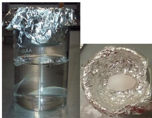
Figura 6. Sistema utilizado para desintegración de supositorios vaginales
