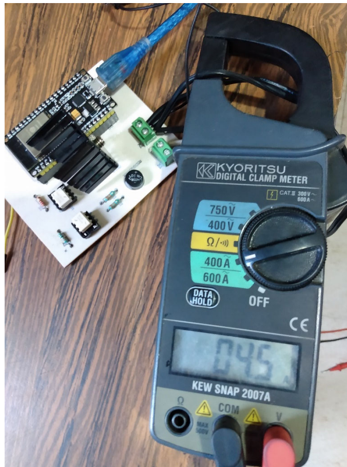
Ilustración 4.13 Medición de corriente real.
