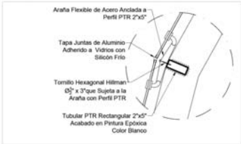
DETALLE UNIÓN DE ARAÑAS
